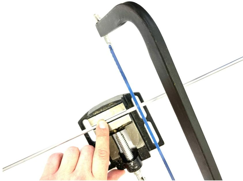
Рис. 3.5: Обрезка трубки до нужного размера
