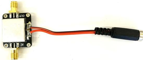
Рис. 3.18: Усилитель с припаянным разъемом
