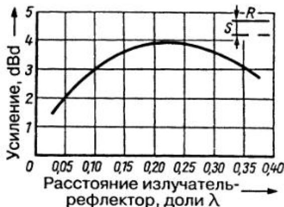
Рис. 2.12: Реальное усиление комбинации излучателя и пассивного рефлектора.
