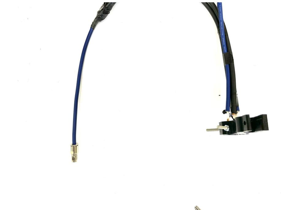
Рис. 3.13: Готовое крепление вибраторов
