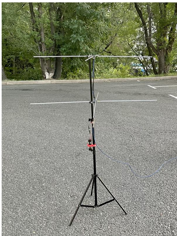
Рис. 3.21: Фотография собраной антенны из набора "Космические данные" от Братя Вольт.
