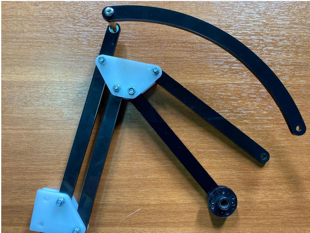
15. Используя 1 винт М3х30, 2 М3 шайбы и 1 самоконтрящуюся гайку прикрепите [деталей 5](#) к нижнему отверстию [детали 2](#), а также используя 1 винт М3х16, 2 М3 шайбы и 1 самоконтрящуюся гайку прикрепите [деталей 7](#) к верхнему отверстию [детали 2](#):
