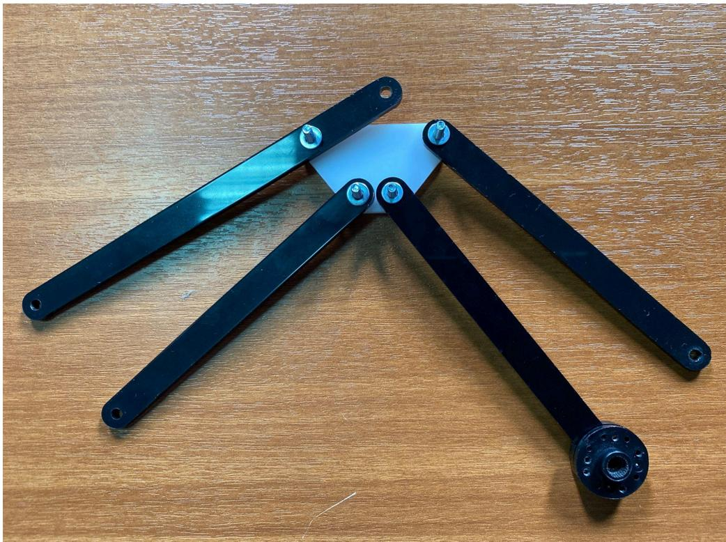
9. В конце оденьте сверху оставшуюся [деталь 4](#) и закрепите 4-мя самоконтрящимися гайками М3. Не закручивайте в полную силу, детали внутри сборки должны ходить свободно, без усилия:
