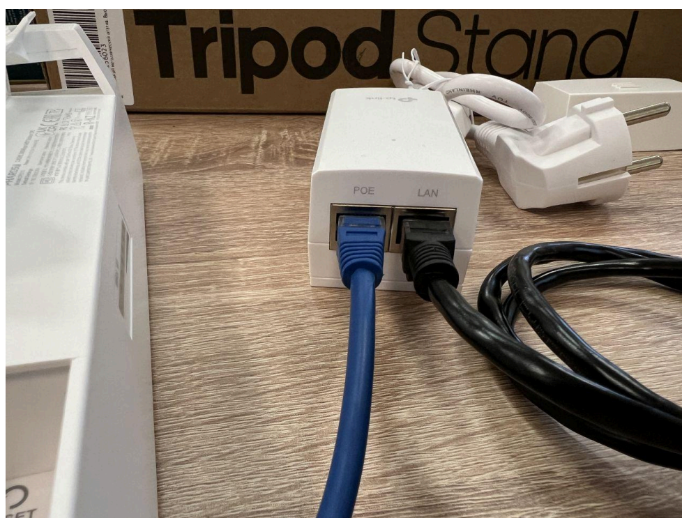
Подключение кабеля к POE адаптеру.
