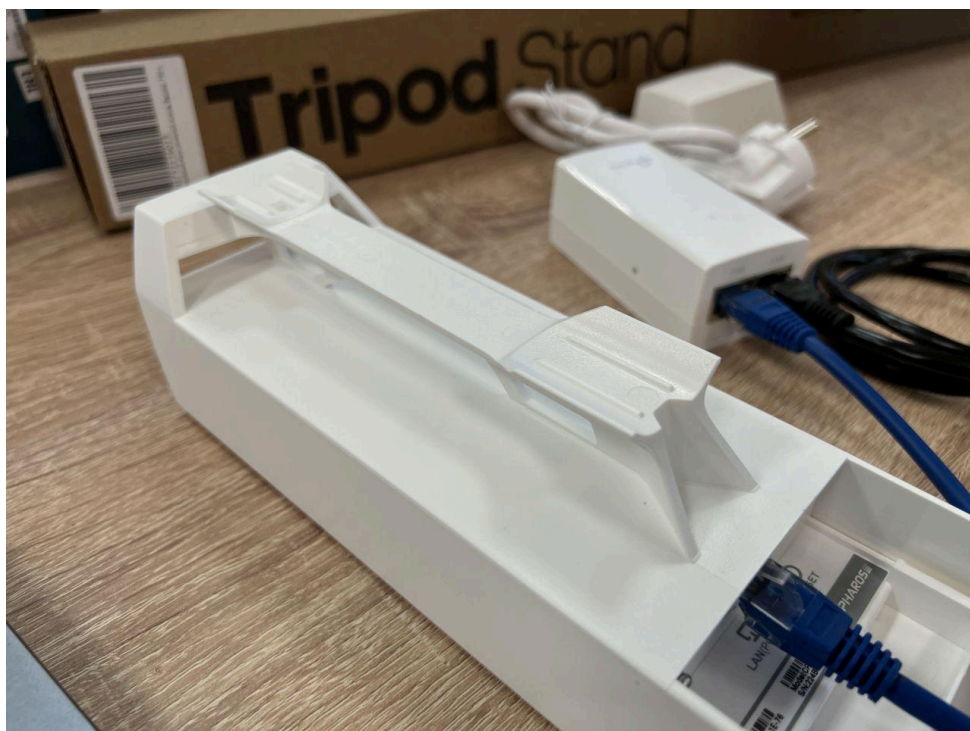
Подключение кабеля к роутеру.
