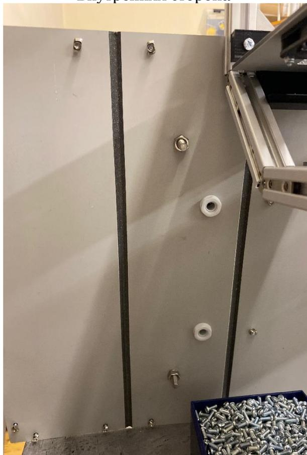
4. Переверните робота и прикрутите поддон. Сначала накрутите середину (не затягивайте). Потом крайние части. В конце закрутите!
