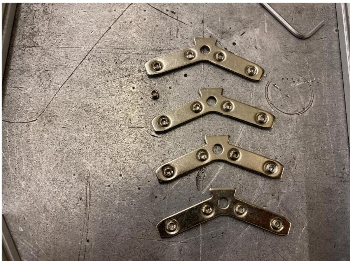
3. Вставить эти уголки в диагональный профиль (100 мм)
