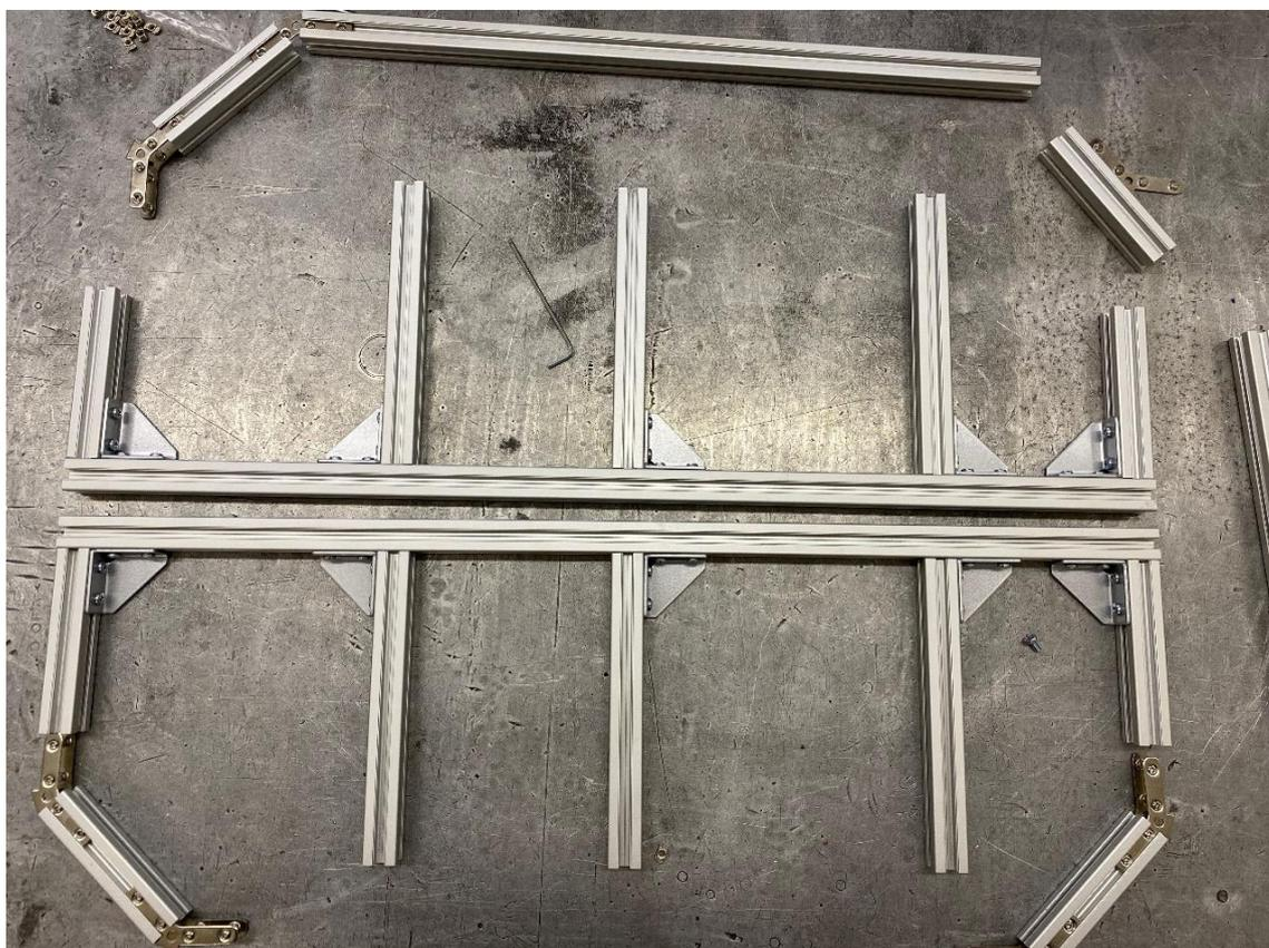
8. Собираем целиком всю боковину. На поперечные балки прикручиваем по еще одному уголку. Выравниваем и затягиваем. В конце затягиваем диагональные уголки
