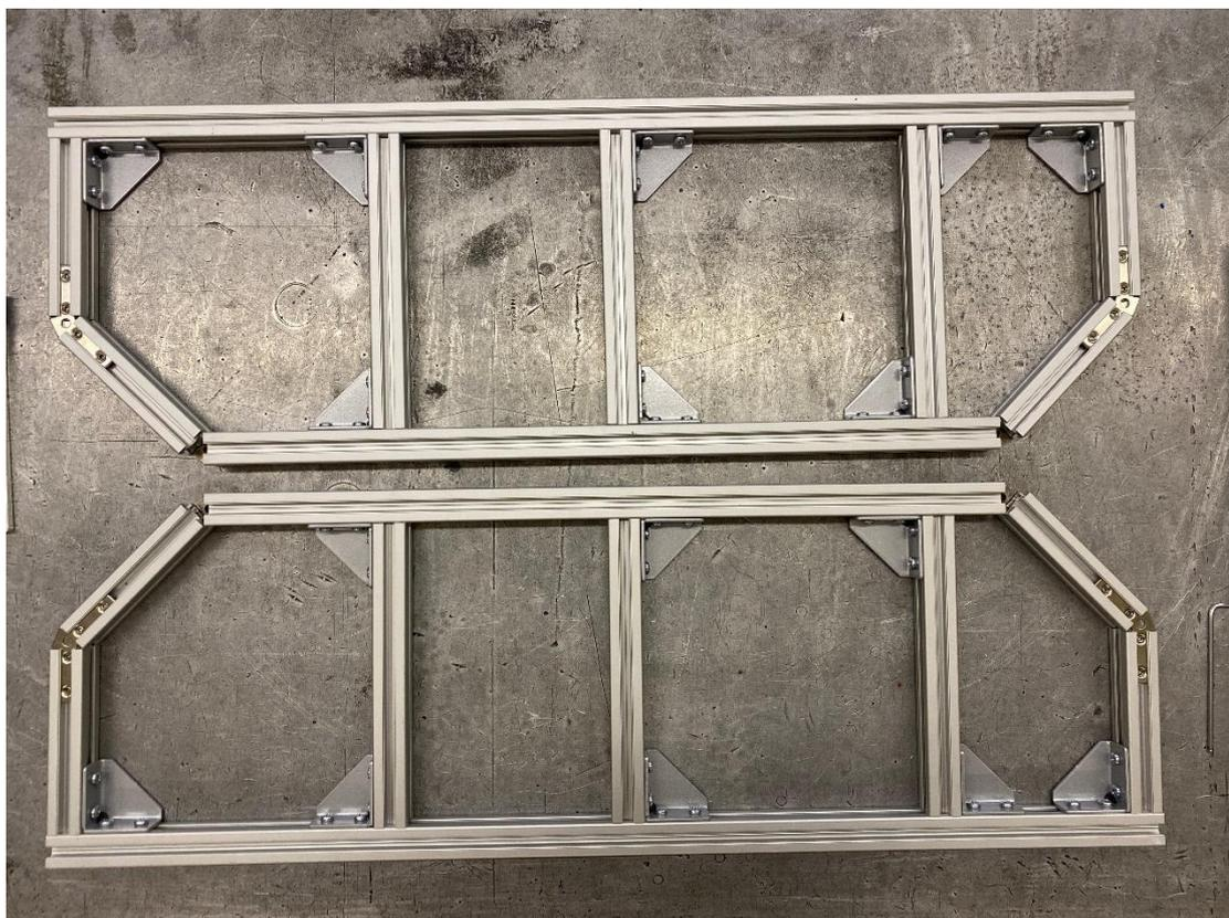
10. Подготовить 4 крепежных пластины. Сначала выберите «красивую» сторону пластины. Предусмотрите, чтобы «красивая» сторона оказалась снаружи при крепеже к профилю (со стороны «некрасивой» стороны будут располагаться Т-гайки М5). Использовать шестигранные винты М5Х12 и Т-гайки М5
