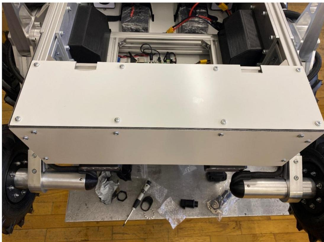
3. На уголки накрутить 4 винта М4х8 и 4 Т-гайки М4
