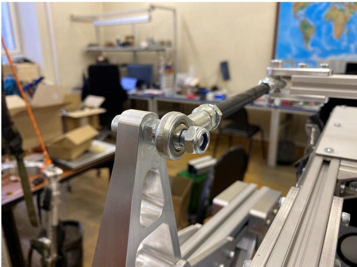
24. Затянуть фланцевые гайки так, чтобы шаровые тяги были перпендикулярны:
