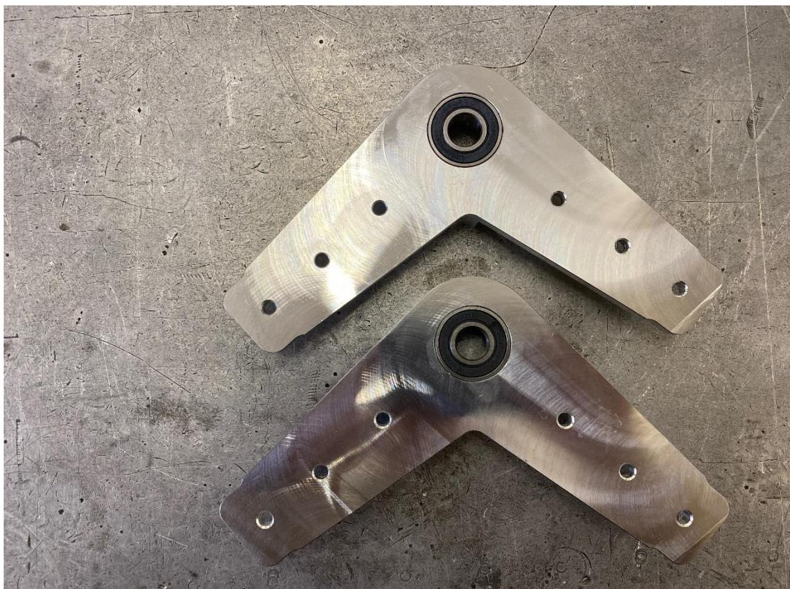
9. Соединить две Г-образные детали с помощью металлической втулки
