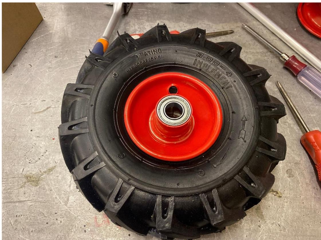
3. С помощью двух отверток и силы Халка вдавить диск внутрь покрышки (только с одной стороны):
