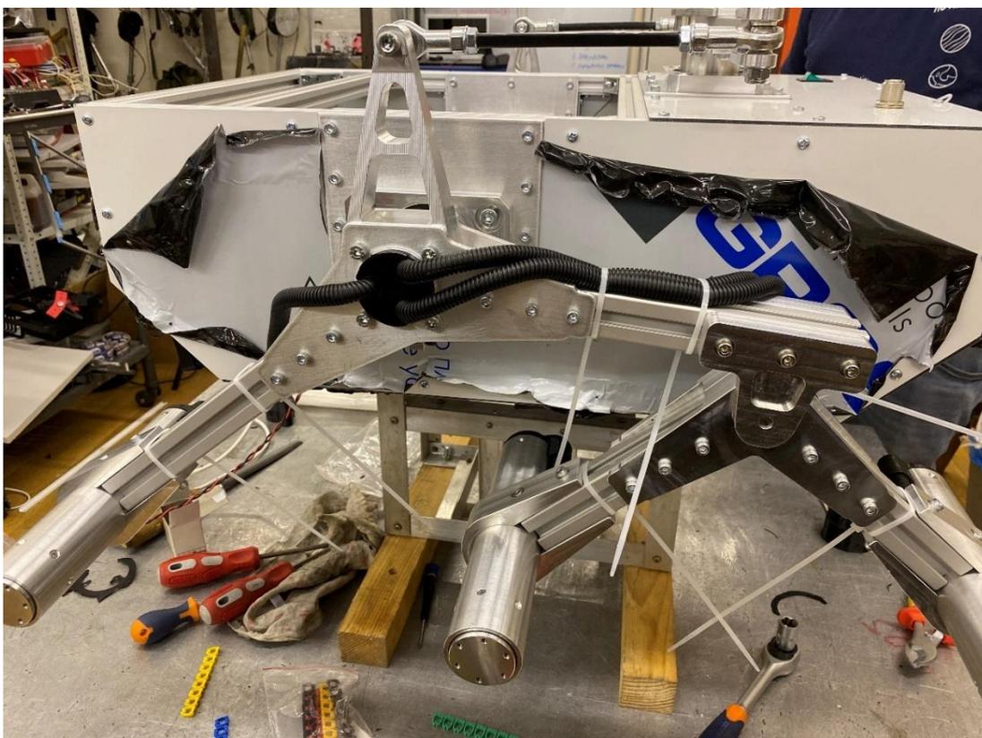
11. Протянуть провода от моторов в специальное отверстие и подключить к роботу. Не забудьте надеть на провода маркеры с цифрами:
