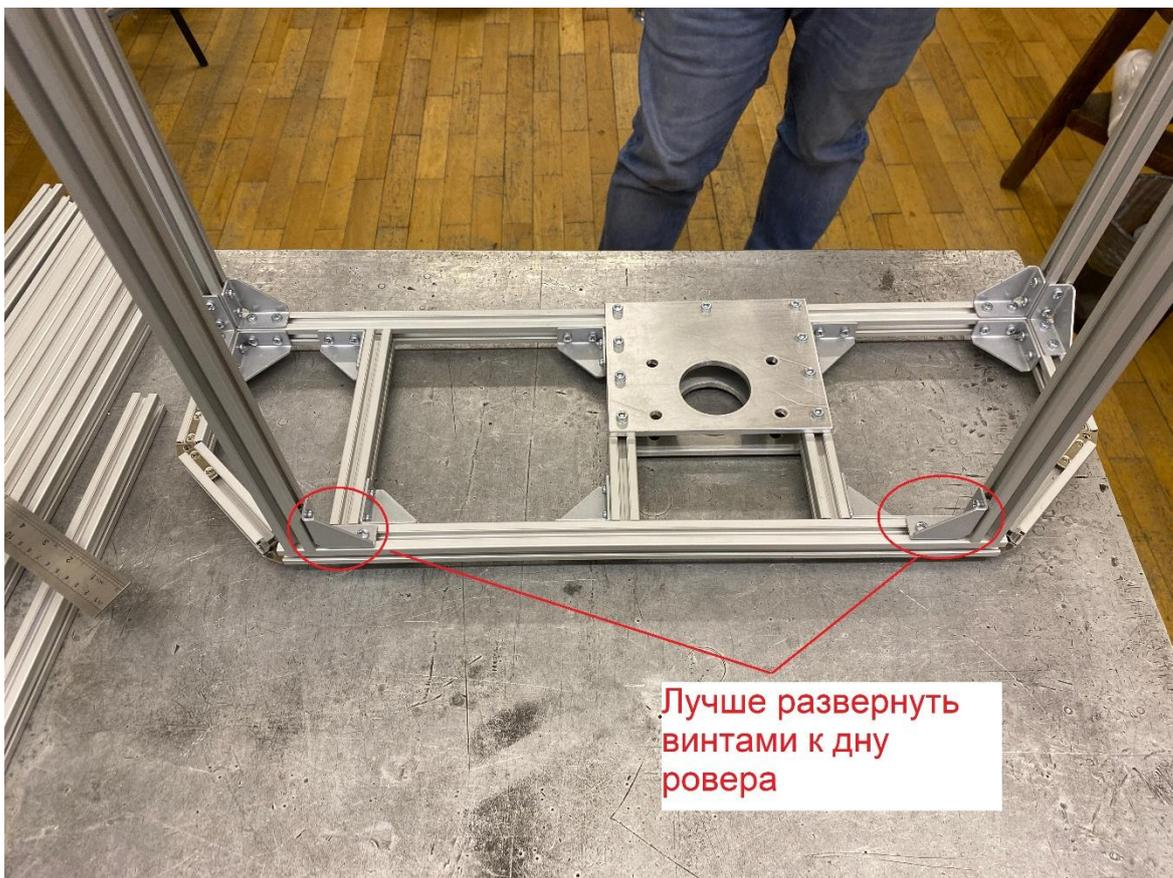
13.3. Устанавливаем нижний средний профиль на расстоянии по 120 мм от крайних профилей:
