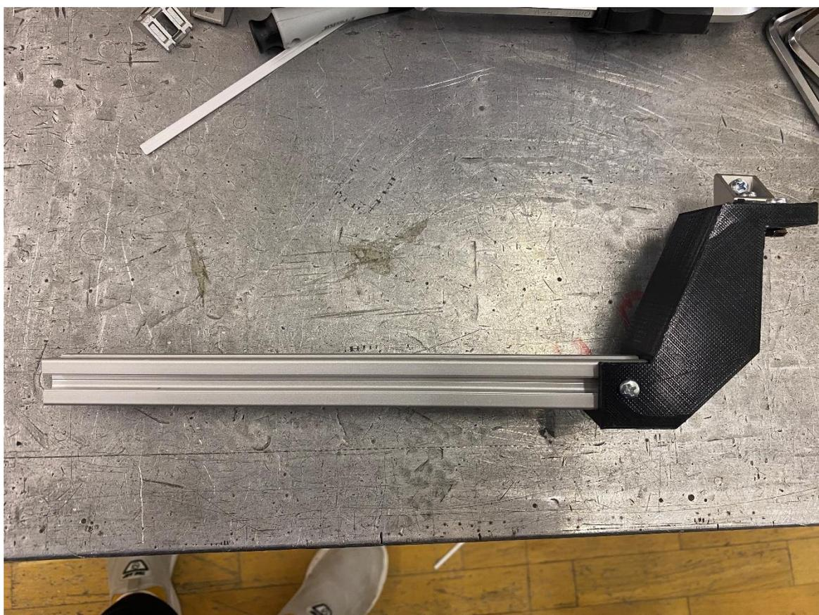
3.7. Крепим эти детали к задней части ровера и не закручиваем
