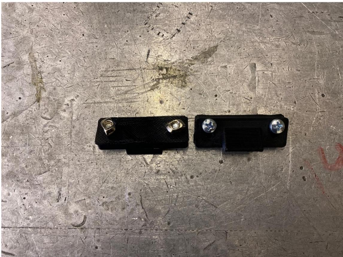
9. Прикрутить защелки к роверу, таким образом, чтобы крышка закрывалась и не «ходила» закрытая и не застревала при открывании
