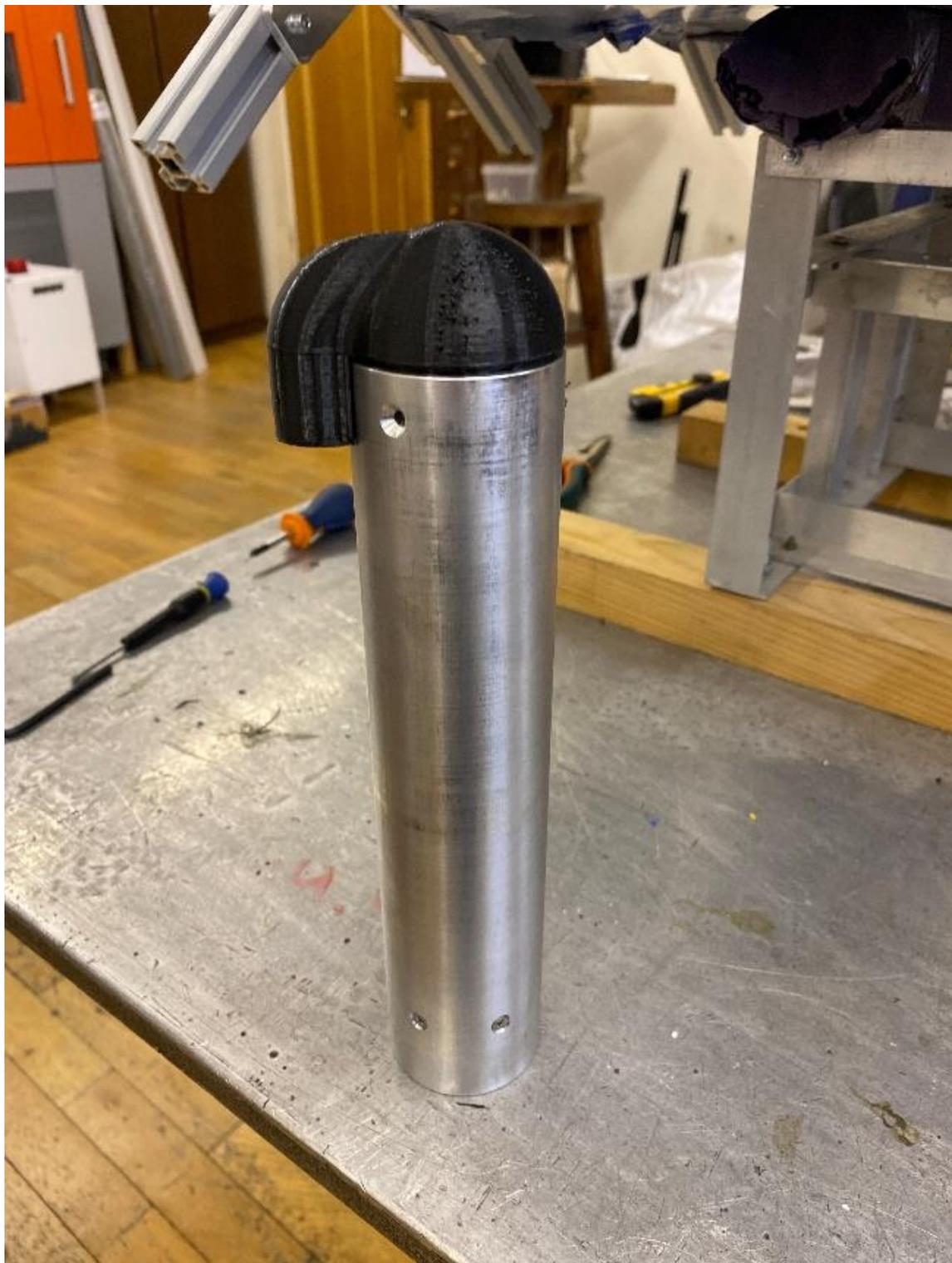
2. Вставить трубку в крепление. Крепление должно располагаться на расстоянии 10 см от заднего края. Также важно, чтобы отверстие под крепление задней втулки было на одной линии с верхней точкой крепления.
