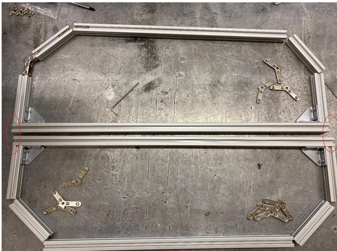
6. На 6 профилей (180 мм) накручиваем по 1-му заготовленному уголку
