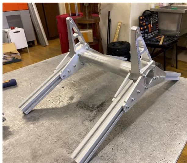
14. Используя 6 винтов М5х25 накрутить Т-гайки М5 на переходное звено подвески
