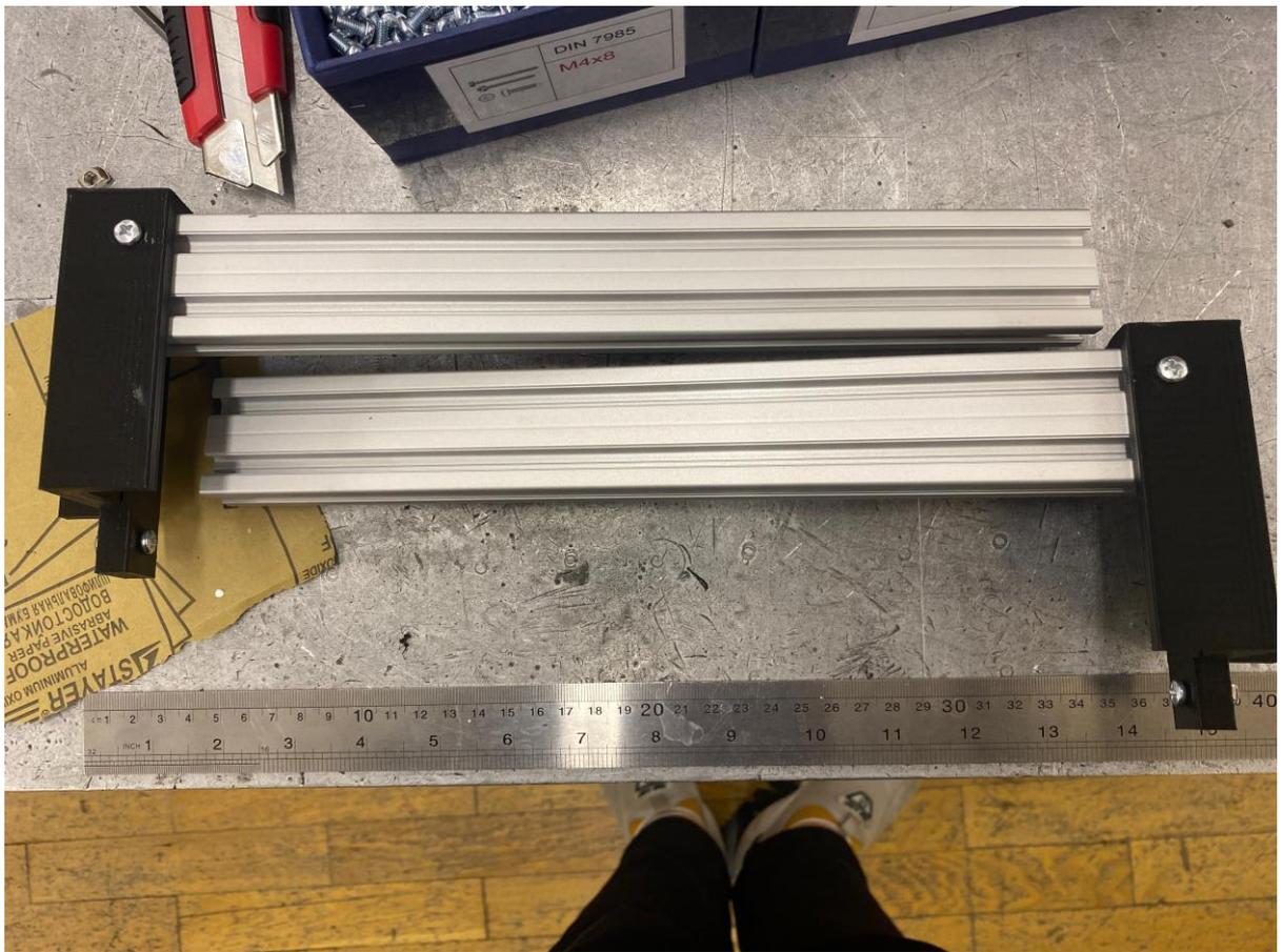
1.3. Устанавливаем детали в переднюю часть ровера. Не затягиваем
