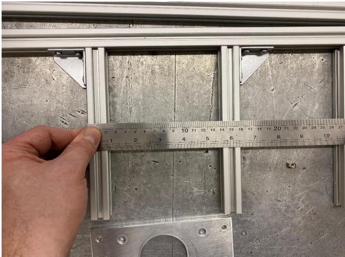
7.4. Последний на расстоянии 140 мм от задней части
