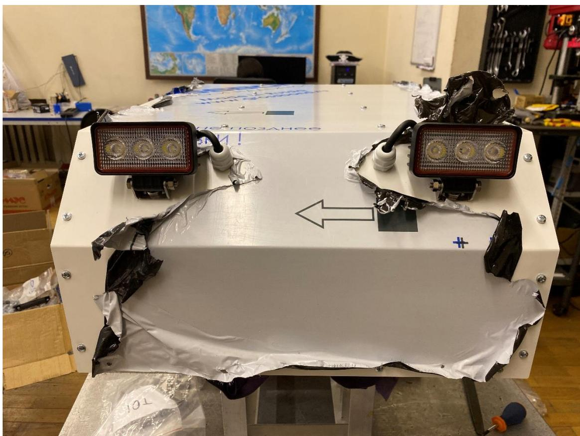
7. Немного отклейте защитную пленку от боковых пластин и накрутите Т-гайки М4
