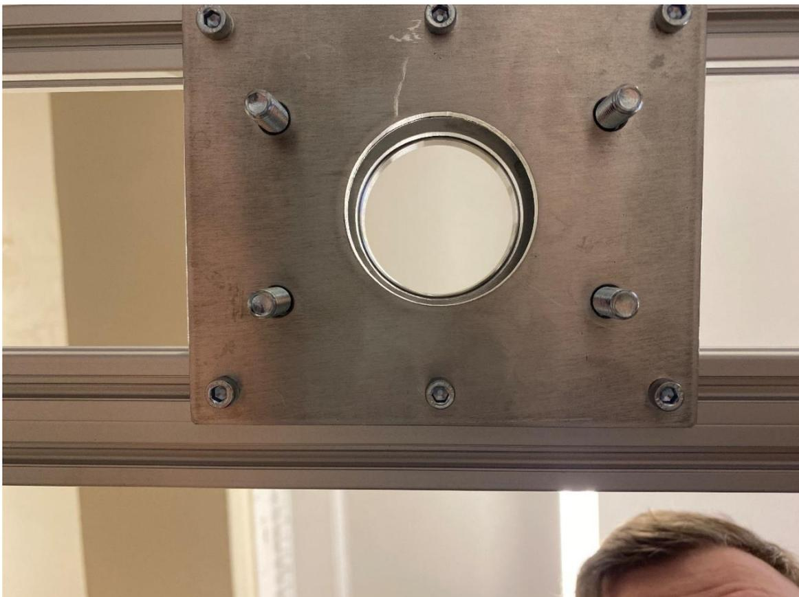
14.6. Установить вторую крепление для подшипников снизу и закрепить стопорными гайками М8. Не закручивать - наживить
