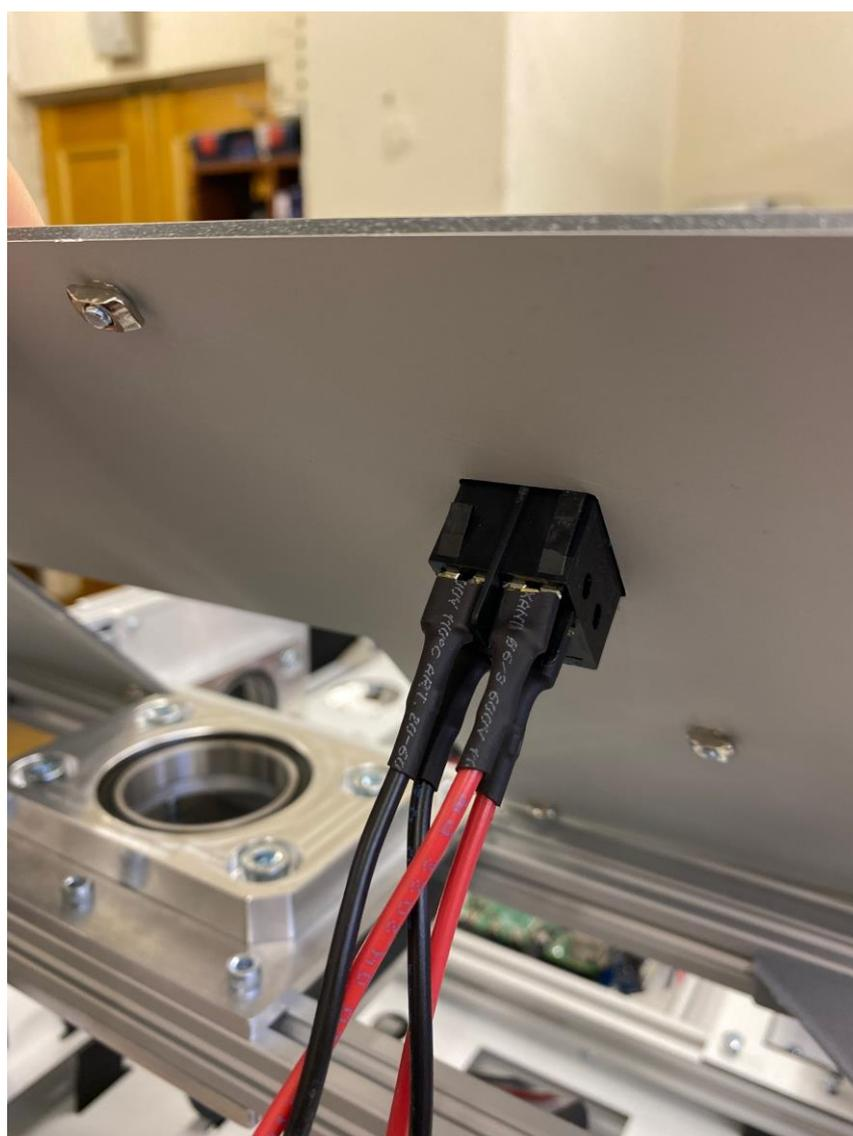
20. Просунуть провода питания в кабель-канал и вытащить из круглого отверстия, подключить кусок кабеля с предохранителем
