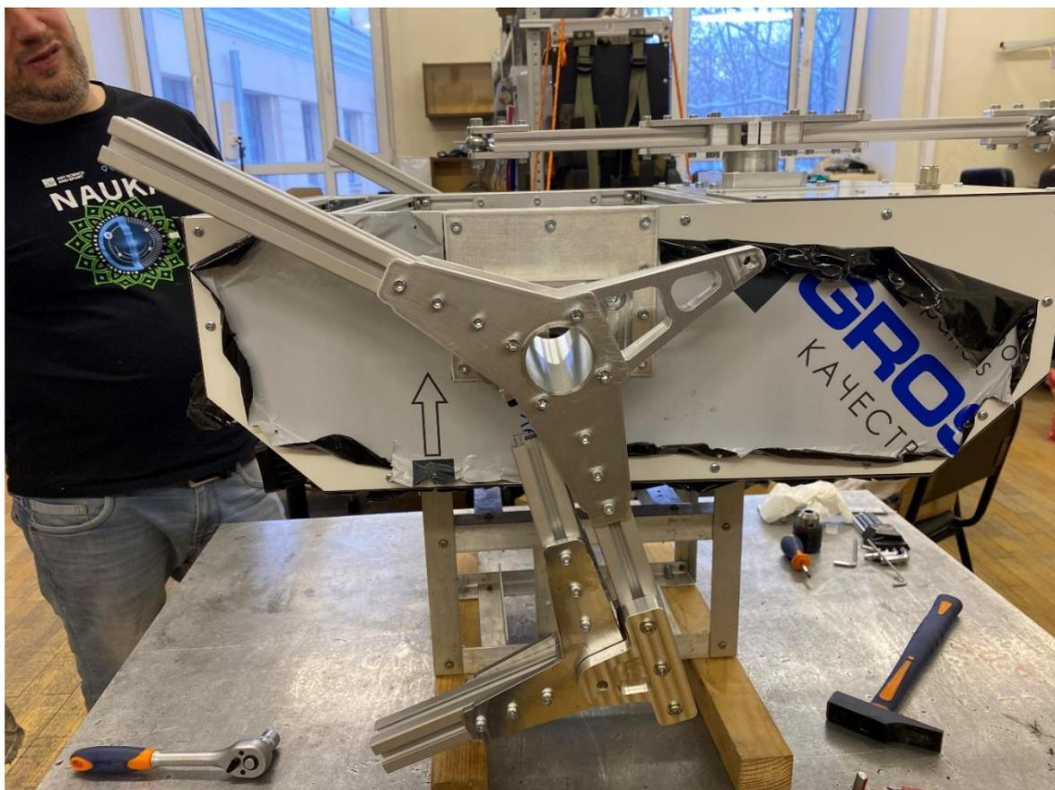
17. Затянуть винты элементов крепления подвески
