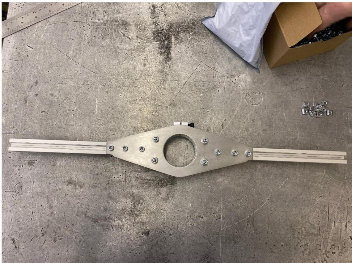
15.6. Подготавливаем 4 пластины для крепления шарниров с помощью винтом М5х12 и пазов-сухарей М5
