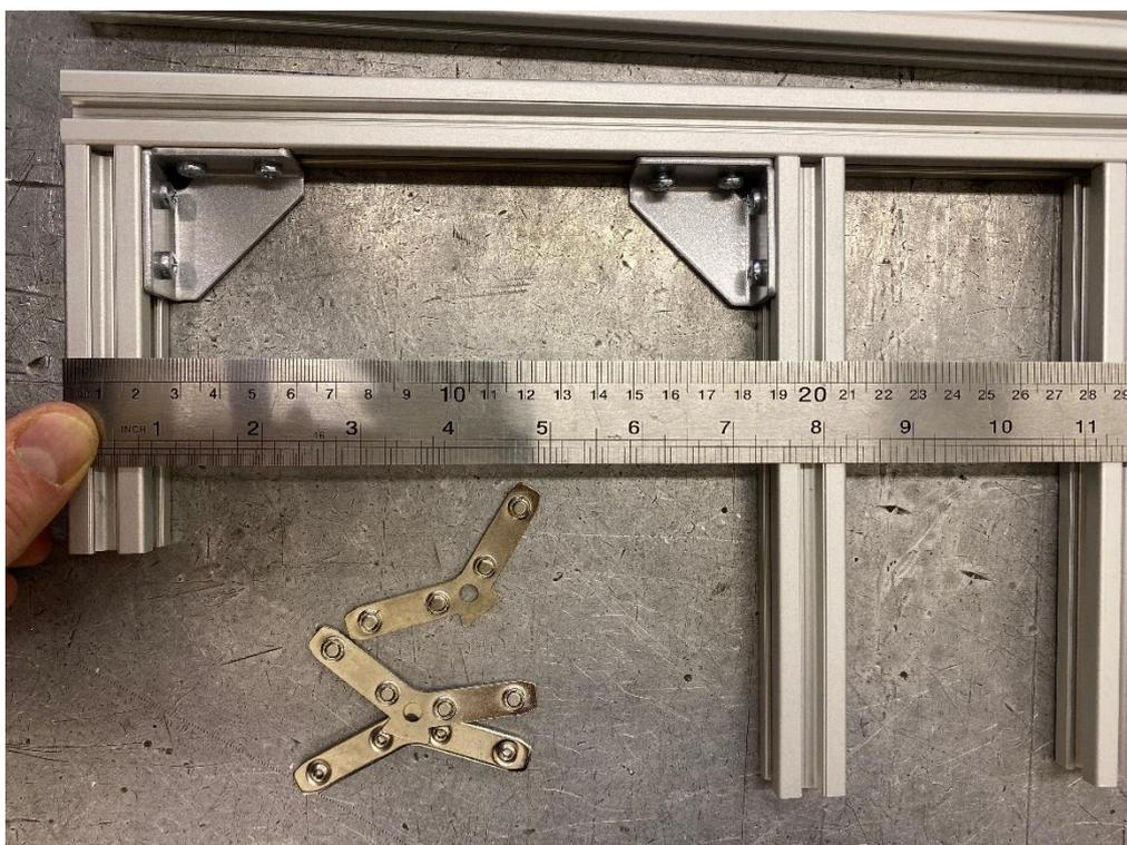
7.3. Следующий на расстоянии 160 мм (опять же направление уголков)
