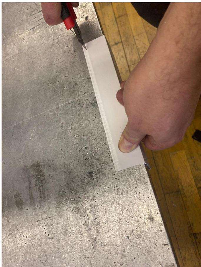
1.5. Выравниваем короб по пластине и снизу маркером ставим две метки для сверла. Ориентировочно, где метки.
