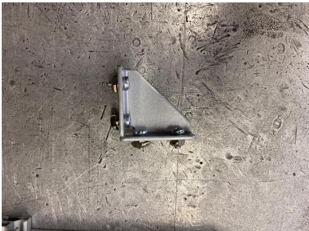
5. Установить уголки как на картинке. Что важно! Выделенные углы должны быть ровными без зазоров (иначе потом будут трудности с обшивкой). Уголки двух боковин должны быть расположены именно как на картинке для того, чтобы потом было удобно затягивать в случае необходимости
