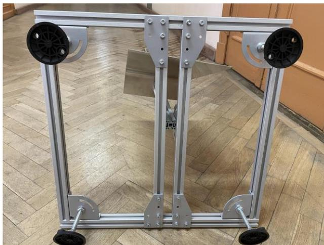
4. Прикрепите 2 поворотных кронштейна крепления к основанию направляющего стержня (элемент алюминиевого профиля 560мм) при помощи винтов М6х10, сухарей пазовых М6 с лапкой и винтов со звездообразной ручкой (или винтов м6 с головкой под шестигранный ключ). Используйте шайбы. На изображении ниже показано крепление одного поворотного кронштейна.
