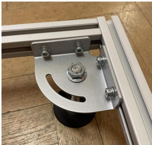
2. Соберите регулируемые опоры и привинтите их к адаптеру для опоры используя по две шестигранные гайки с фланцем для каждой из четырех опор.
