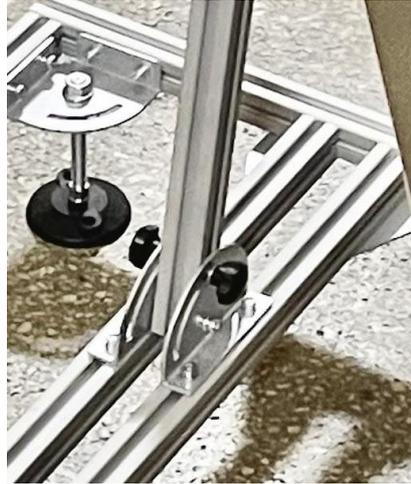
6. Прикрепите направляющий стержень с пусковым клапаном в сборе к основанию направляющего стержня с помощью винтов М6х35, т-гаек М6 и нужного количества проставочных шайб, как показано на изображении ниже.
