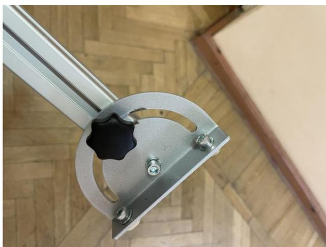
5. Установите поворотные кронштейны крепления на параллельные перемычки рамы основания и привинтите их при помощи винтов М6х10 и т-гаек М6. Проверьте возможность регулировки угла наклона основания направляющего стержня и возможность его фиксации в нужном положении при помощи звездообразных ручек.
